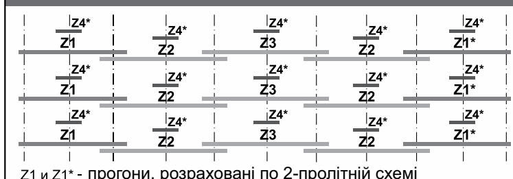
Монтажна схема прогонів для прольотів L > 6000 Ухил площини покрівлі \leq 14^\circ (25%)
